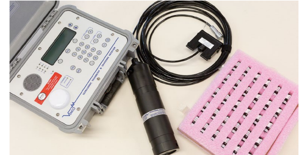
Transmissors i receptors d'ultrasons per facilitar la recopilació de dades dels exemplars marcats.
