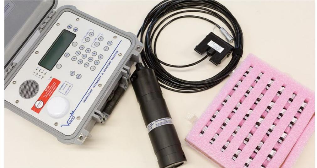
Transmisores y receptores de ultrasonidos para facilitar la recopilación de datos de los ejemplares marcados.
