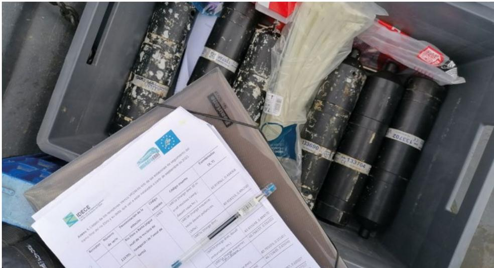
Receptores submarinos instalados a finales de octubre de 2023 en el tramo final del río Ebro para detectar los movimientos de los esturiones.
